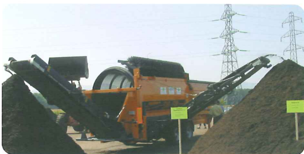
Criblage du compost
