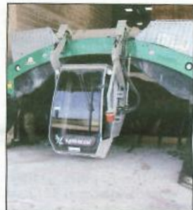
L'entreprise utilise un matériel spécifique tel que ce retourneur d'andains automoteur.
